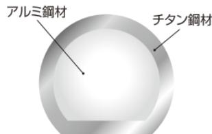
ローラーの内側には、熱伝導率の高いアルミ鋼材を使用。ローラーの外側には、変化が極めて低く、物性が安定しているチタン鋼材を使用し、金属アレルギーの方にも配慮しました。
